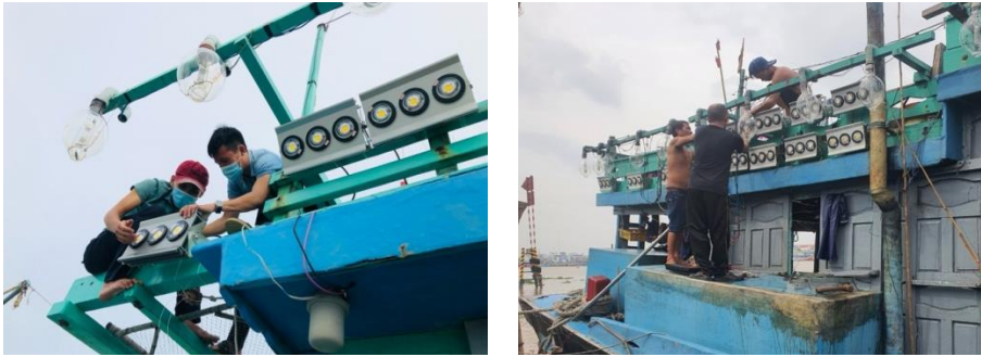
Hình 8. Lắp đặt công nghệ đèn LED cho tàu đánh bắt xa bờ [8]
