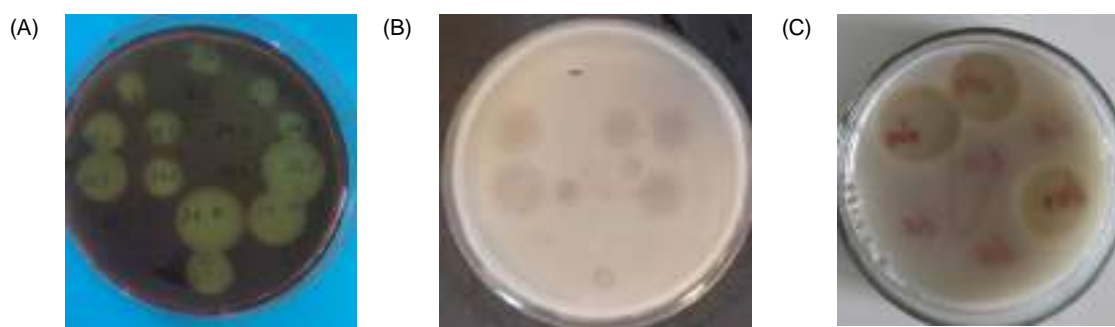
Hình 1. Sàng lọc vi khuẩn biển sinh enzyme chuyển hóa polysaccharide theo phương pháp đĩa thạch: (A): Alginate; (B) Fucoidan; (C) Ulvan; các vùng sáng là những vòng phân giải polysaccharide
