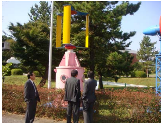
Hình 1. Máy phát điện sử dụng năng lượng dòng chảy biển trưng bày tại Đại học Nihon, Nhật Bản (10/2009)
